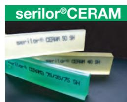
Racle haute résistance en basses duretés de 35 à 55 shA destinée à l'impression directe sur céramique ou sur carrelage. Egalement disponible avec une couche centrale molle et des bords en 75 shA pour des impressions sur support arrondi (CERAM 3).
