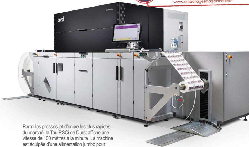
Parmi les presses jet d'encre les plus rapides du marché, la Tau RSCi de Durst affiche une vitesse de 100 mètres à la minute. La machine est équipée d'une alimentation jumbo pour accueillir une bobine de 1 000 mm de diamètre.
